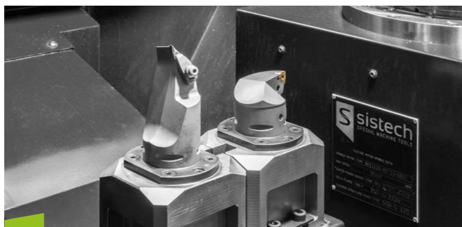
Utensili fissi per lavorazioni di tornitura pesante, attacco capto C6 Fixed tools for heavy turning operations, tool holder capto C6
