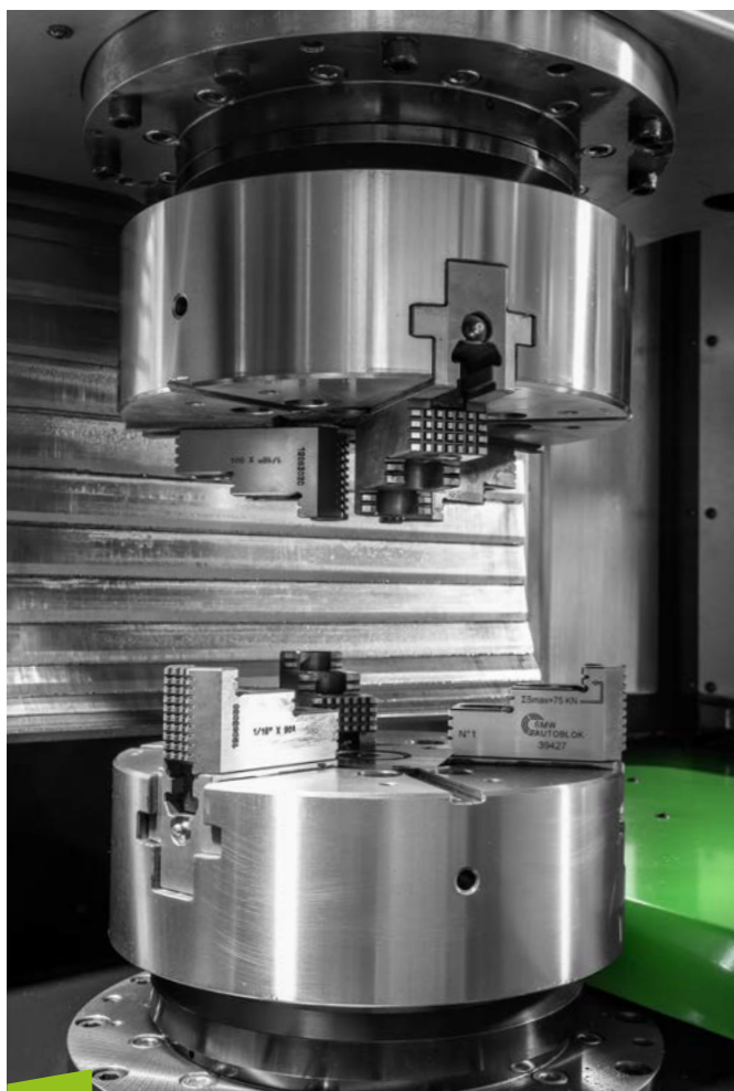
Mandrino OP10 e contromandrino OP20 Posizione di scambio pezzo OP10 spindle and OP20 counter spindle Part exchange position
